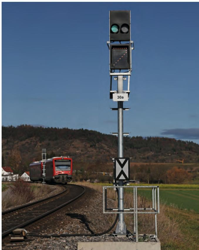
**Bild 5: Einfahr-Vorsignal mit Geschwindigkeitsanzeiger vor Entringen**
